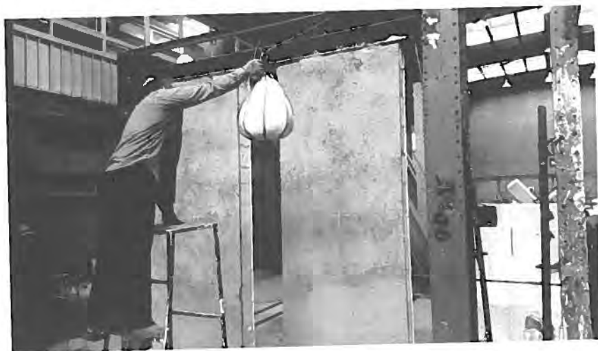
شکل (۵-۱) آزمایش ضربه جسم نرم سنگین
